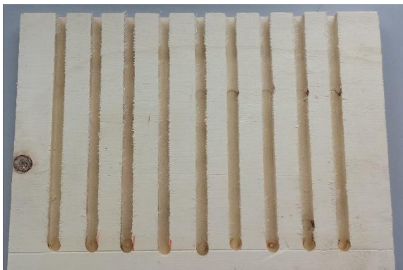
Brettchen nach dem Fräsen der Nuten
